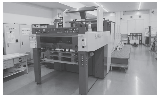
A全判寸延び4色オフセット印刷機「LTHRONE A37」(H-UV搭載)
